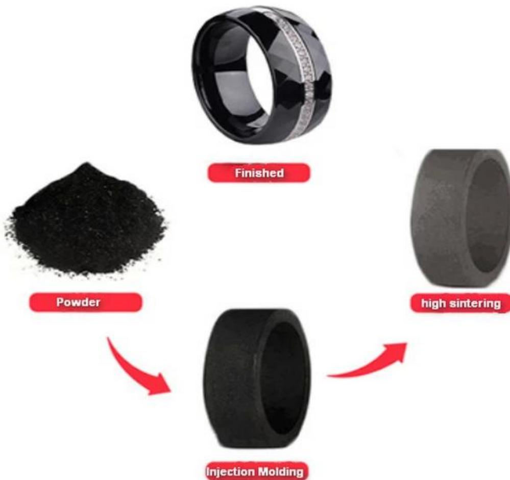
Высокоточные керамики и порошки сплава из драгоценного металла смешиваются и уволены, а после нескольких точных и строгих процедур и многократной полировки и полировки машины они, наконец, интегрированы в дизайн ювелирных изделий. Эта керамика не только устойчива к свету и износу, но также имеет античувствительные свойства и удобно носить. Это одна из самых модных ювелирных материалов на данный момент и предпочитает крупные ювелирные бренды.
